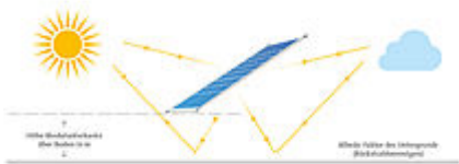
Abbildung 3: Bifaziales Solarmodul (Quelle: SolarWorld Industries GmbH)
