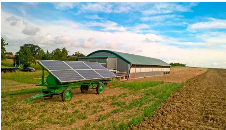
▣ Bild 2: Energieautarker, mobiler Legehennenstall mit Photovoltaikanlage auf Rädern in Mittelfranken (Foto: AELF Uffenheim)
